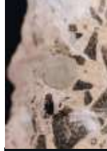
Powierzchnia stalowa pod warstwą rozprężoną żywicy w próbie zanurzeniowej
