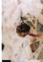
Powierzchnia stalowa po eksploatacji w stanie nie chronionym w próbie zanurzeniowej
